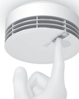
Alle signalisierenden Rauchwarnmelder einzeln durch Drücken der Testtaste innerhalb von 15 Minuten bestätigen. Nach Bestätigung aller Rauchwarnmelder ist die Funk-Inbetriebnahme abgeschlossen. Sämtliche Funk-Rauchwarnmelder blinken von nun an alle 48 Sekunden grün (Genius Hx und Funkhandtaster Genius blinken rot).
