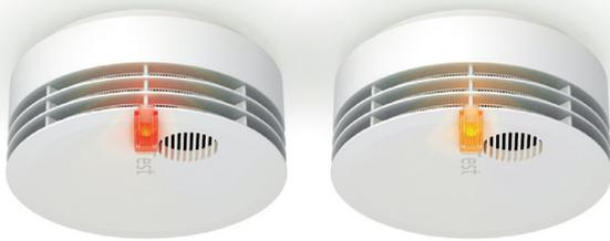
Lokalisieren Sie den in Störung befindlichen Funkteilnehmer im Funknetzwerk (Linie). Der direkt betroffene Teilnehmer blinkt alle 8 Sekunden (rot oder orange) und piepst alle 48 Sekunden kurz. Weitere Informationen finden Sie hier: „Lokalisierung von Funkmeldern in Störung“
